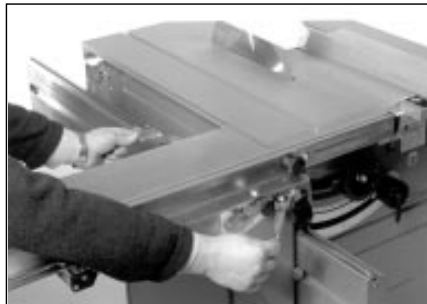
Den Schiebetisch auflegen und mit den beiden Spannhebeln festspannen.
